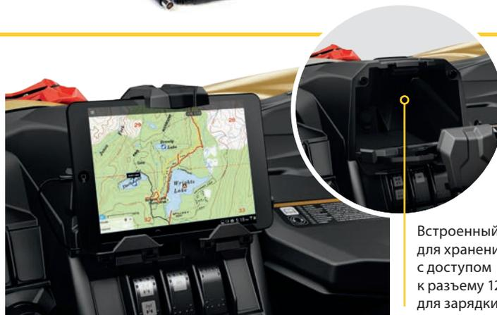
Встроенный отсек для хранения с доступом к разъему 12 В для зарядки электронных устройств
