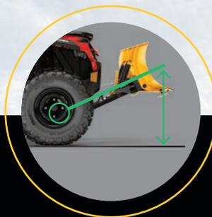
Переднее размещение рамы обеспечивает максимальную высоту подъема.
